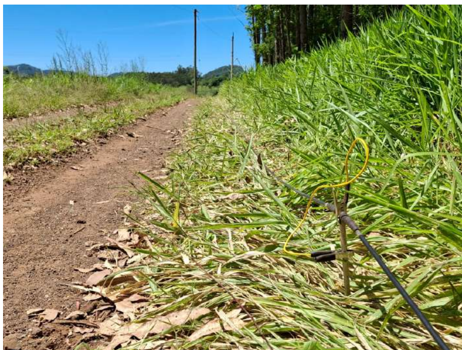
Foto 03. Levantamento geofísico por imageamento elétrico.
